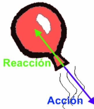
Figura 2: Fuerzas de acción y reacción sobre un globo que se suelta después de ser inflado.
